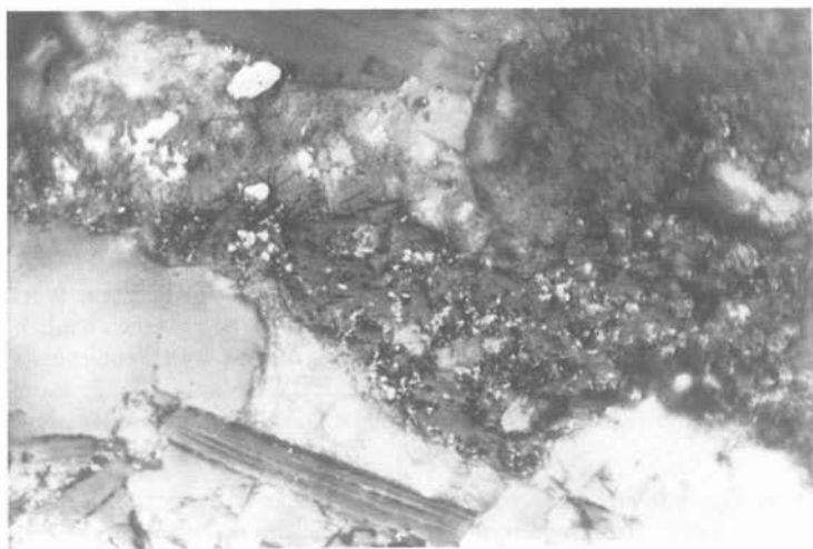
Abb. 1: Fein verteiltes \text{UO}_2 (schwarze Punkte im Bindemittel) in den Serizitquarziten der Phyllit-Serie, Lenz im Kalteneegg, südöstlich von Rettenegg (Stmk.). 450fach.
